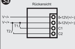
**Spannungsversorgung mit =~/~8-12V (0,5A)**
