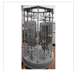
Chromované mosazné panely nebo panely z nerezové oceli jsou uchyceny na speciálních rámech.
