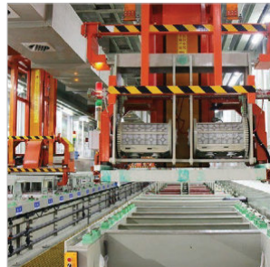
Chromovací a niklovací linka k potahování mosazných desek ochrannými vrstvami.
